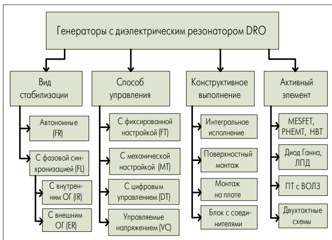
Рис.3. Классификация СВЧ-генераторов с диэлектрическими резонаторами
