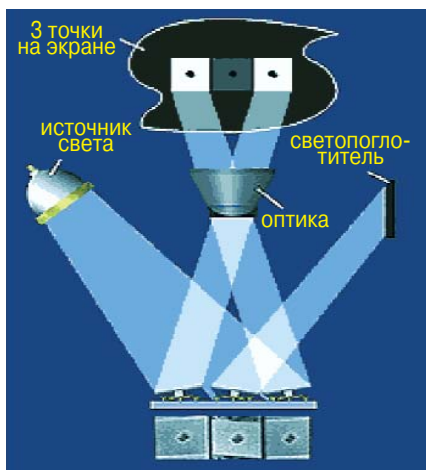
Принцип формирования изображения с помощью DMD-матрицы
