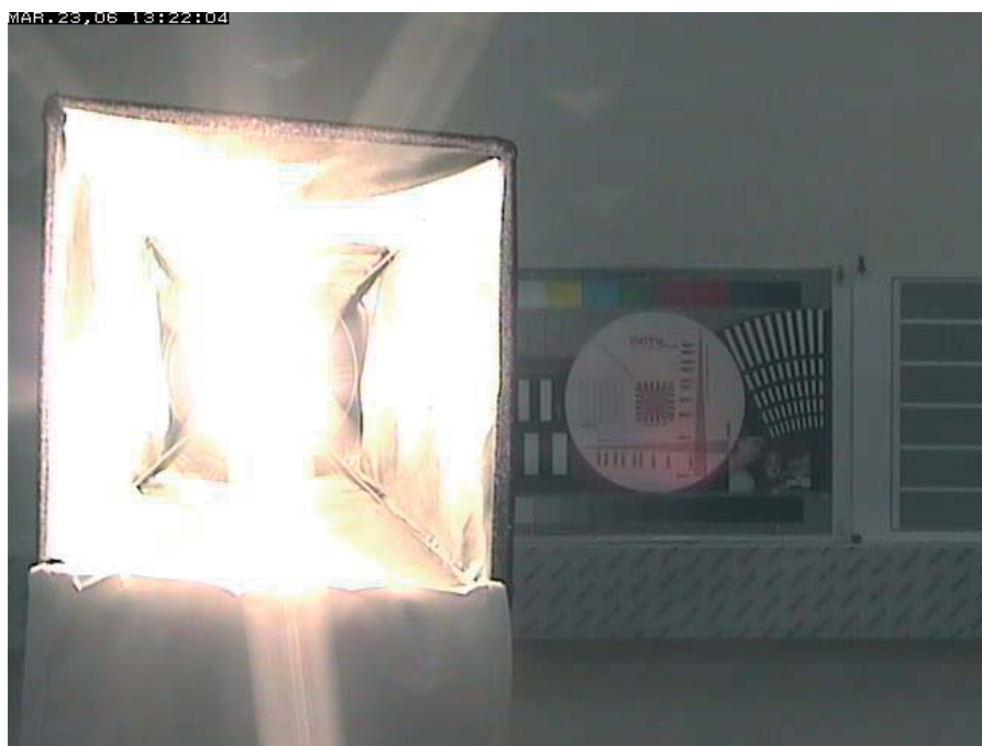
Мощность лампы 600 Вт, расстояние 2м, освещенность таблицы 350 лк.
