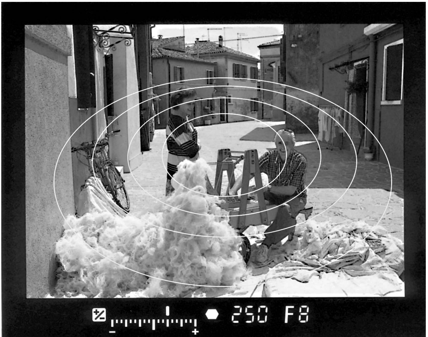
Индикация экспонометра в современном зеркальном фотоаппарате.
