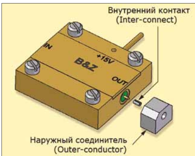
▲ Рис. 29. Внутренний контакт (interconnect) и наружный соединитель (outer conductor) корпуса Ultra Package
