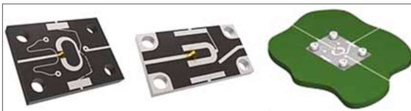
▲ Рис. 31. Смесители компании Pulsar Microwave без внешних соединителей в drop-in-исполнении и принцип их установки на монтажную плату
