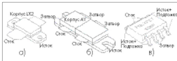
Рис.2. Варианты корпусов для однотактной (а), двухтактной (б) схем включения и корпуса для поверхностного монтажа (в)
