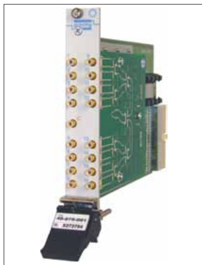
▲ Рис. 1. Модуль с одним 16-канальным мультиплексором с соединителями SMB (модель 40-875-001)
