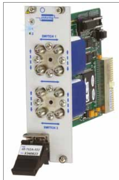
Рис. 3. Модуль с двумя трансферными переключателями для рабочих частот до 18 ГГц (модель 40-782A-522)
