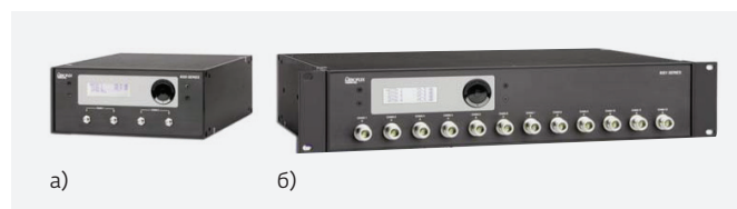
Рис.7. Программируемые аттенюаторы, выпускаемые компанией API Technologies: а – модель 8320, б – модель 8321
