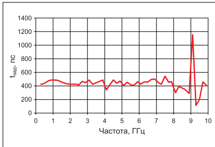
Рис. 21. Зависимость групповой задержки от частоты для пределителя UXD20P
